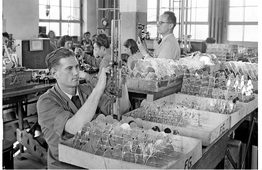
Hier werden Zählerscheiben aus Aluminium oder Kupfer vor dem Einbau in die Elektrizitätszähler gerichtet. Die Aufnahme stammt aus dem Jahr 1952.
