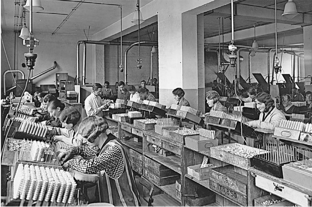
Auf dieser Aufnahme aus dem Jahr 1929 ist die Fabrikation von Rollenzählwerken zu sehen, die später das Ablesen des Zählerstandes erlauben.
